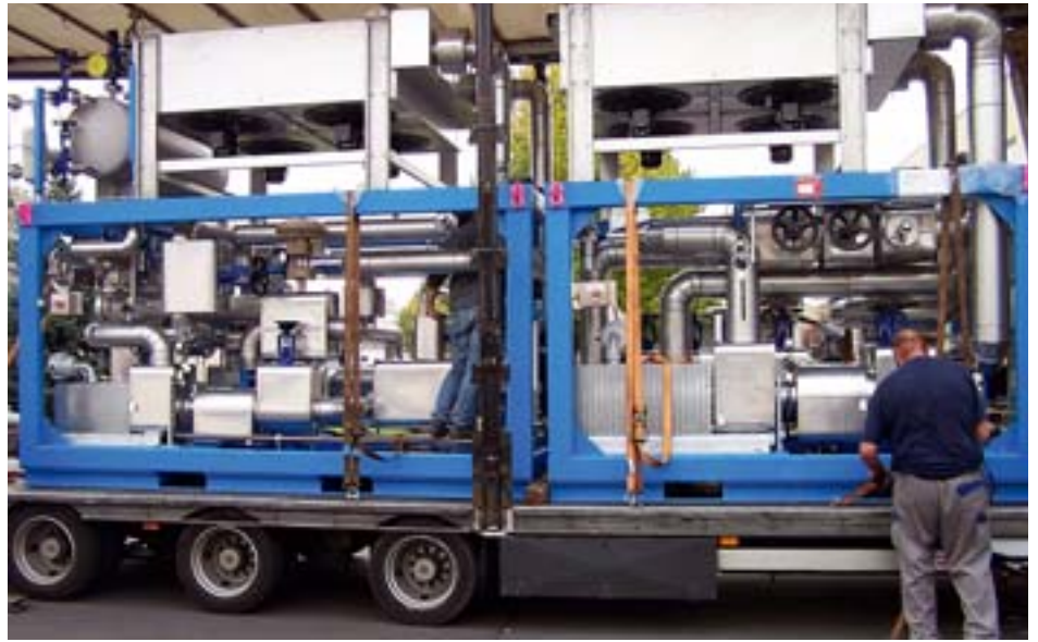
Sekundärkreisanlage in Atex-Ausführung mit aufgebautem Luftkühler
