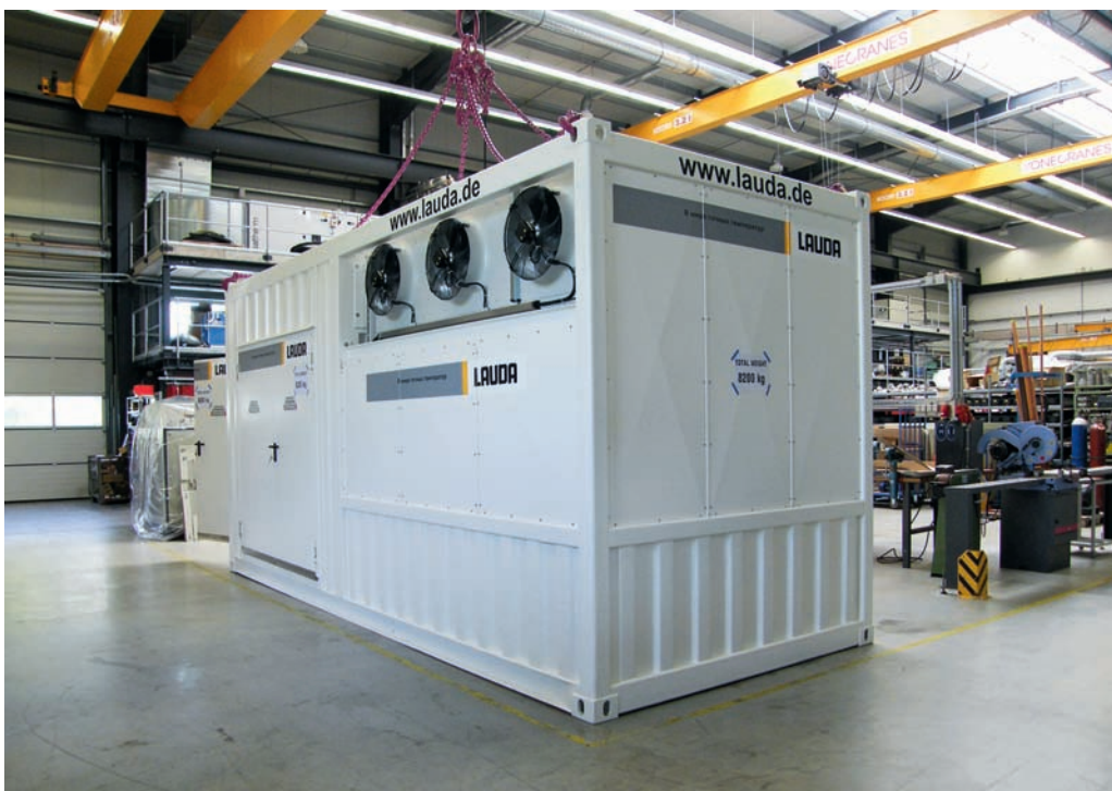
Containeranlage mit Klimatisierung des Maschinenraums für Russland
